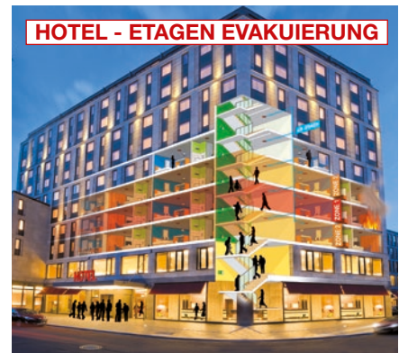
Bereichsbezogene Etagen-Evakuierung eines Hotels durch Sprachalarmierung
