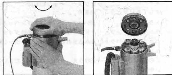
Die Abdeckhaube am hinteren Ende des Gerätes ist abzuschrauben (durch Drehen gegen den Uhrzeigersinn), dadurch wird das Batteriefach freigelegt.
