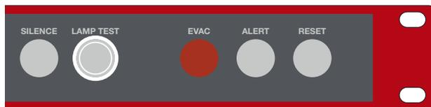
Drücken, um den Lampentest an der Bedieneinheit des NCC-2000A und der angeschlossenen Verstärker und den Signalgeber auszulösen.
