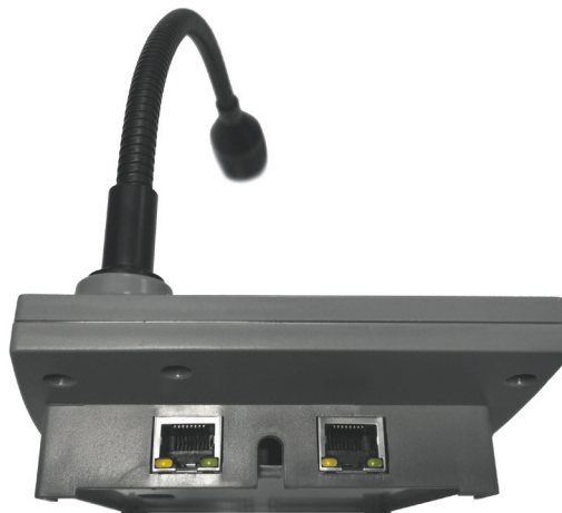
NTM-106 A: L-Net Anschlüsse an der Rückseite
