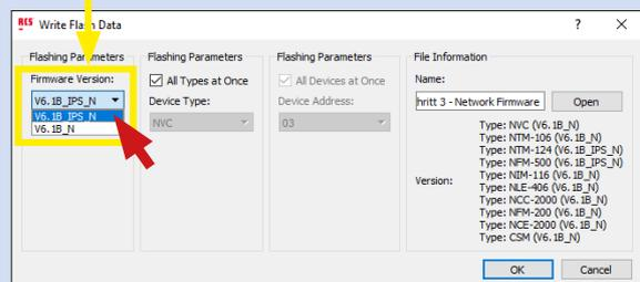
Das gesamte Bussystem L-Net / G-Net wird nun mit der ausgewählten Firmware versehen. Anschließend wird in der Spalte „**SW Version**“ der aktuelle Stand angezeigt. Nun kann das Unterprogramm geschlossen werden **(ACHTUNG: vorher muss zwingend „Disconnect“ ausgeführt werden!!)** und der Prozess ist abgeschlossen. Die Anlage macht automatisch einen Reboot.
