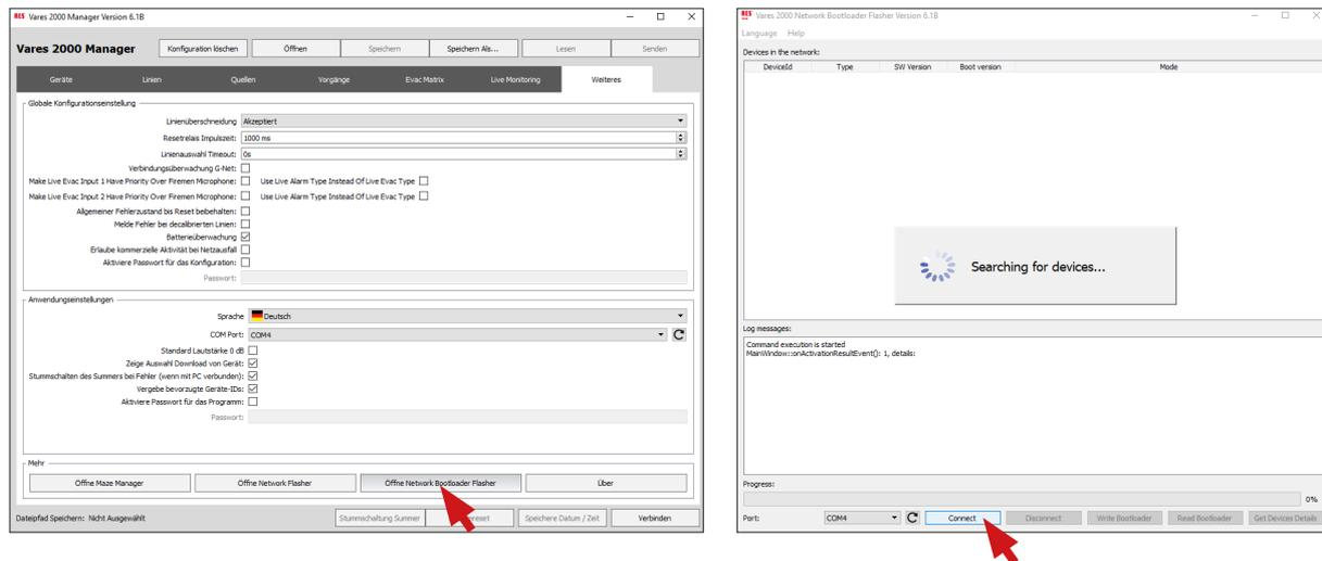
Als Ergebnis erhält man eine Übersicht aller Busteilnehmer im System mitsamt DeviceID, SW-Version und Boot-Version. In der Spalte „**Boot Version**“ bedeutet der Ausdruck „255.255“, dass das entsprechende Gerät noch per USB upgedatet wird.
