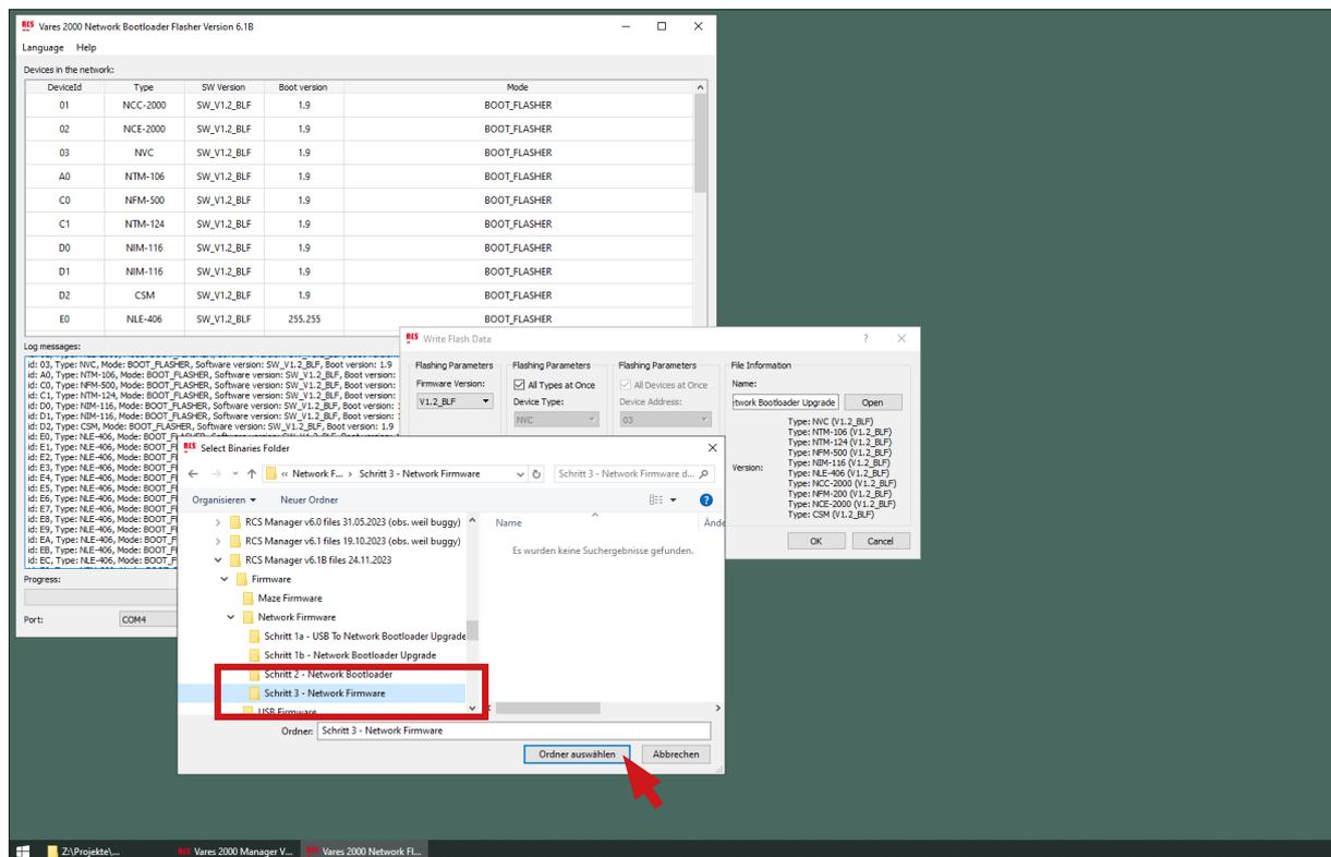
Nach Auswahl „Write User Flash Memory“ wählt man den Ordner „Schritt 3 - Network Firmware“ aus. Hier werden keine einzelnen Dateien angezeigt, da alle Dateien im Ordner verwendet werden.
