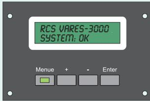
Displaymodul zur Anzeige aktueller Betriebszustände, System- und Fehlermeldungen. Bedienung erfolgt über 4 Tasten an der Gerätefront.
