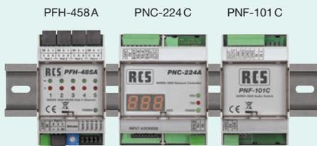
5-kanaliger, potenzialfreier RS485-Hub für Hutschiene montage. Sternförmige Verdrahtungen von RS485-Bussen möglich.
