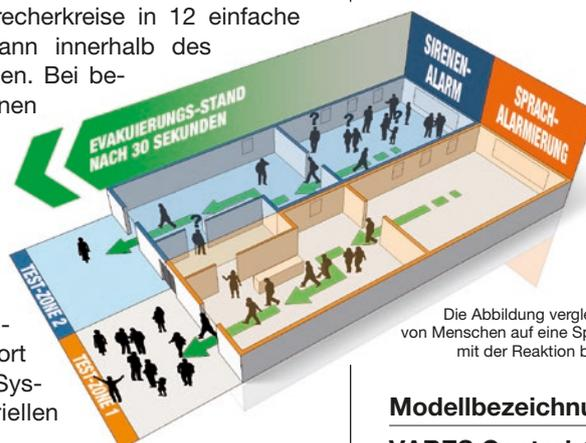
Die Abbildung vergleicht die Reaktion von Menschen auf eine Sprachalarmierung, mit der Reaktion bei Sirenen-Alarm.
