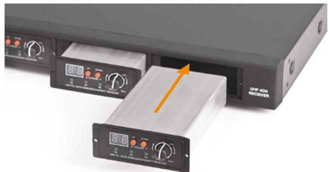
UHF-Empfangsmodul in True Diversity-Technologie zum Einbau in den UR-016B/C. Das Display dient zur Anzeige des gewählten Kanals. Es können pro Basisgerät UR-016, maximal vier Empfangsmodule installiert werden.
