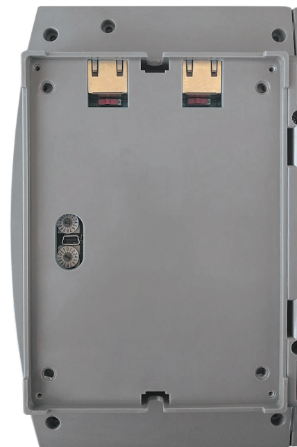
NFM-400 A Ansicht der Unterseite: Drehschalter zur Adressierung und USB-Anschlussbuchse
