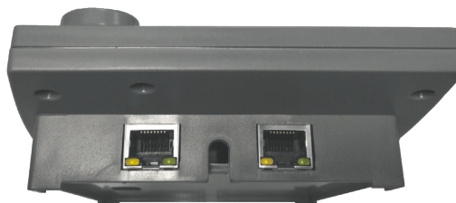
NFM-400A: L-Net Anschlüsse an der Rückseite
